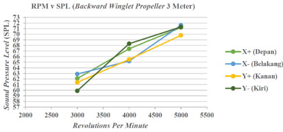
Gambar 40. Grafik hasil pengukuran kebisingan pada backward winglet propeller pada jarak 3 meter
