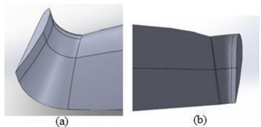
Gambar 20. Gambaran (a) winglet menghadap atas z+ ( upward ) dan winglet menghadap bawah z- ( backward )
