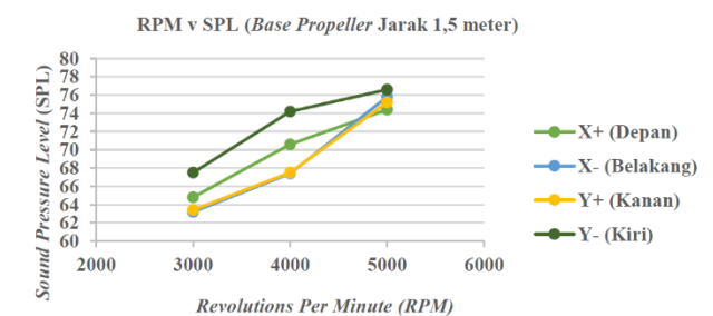
Gambar 33. Grafik hasil pengukuran kebisingan pada base propeller pada jarak 1,5 meter
